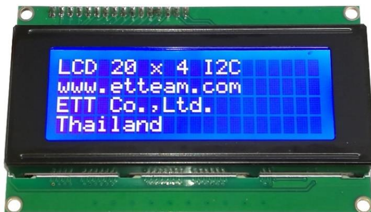
รูปภาพที่ 2.44 จอ LCD ขนาด 20 x 4
