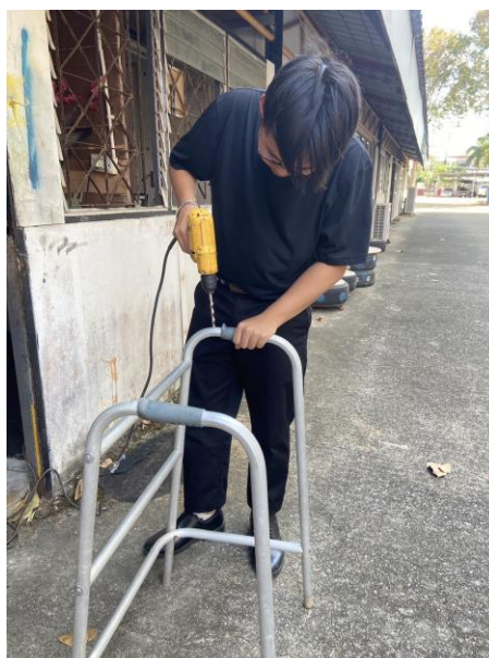
รูปภาพที่ 3.4 วัดขนาดและเจาะไม้เท้า
